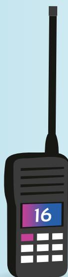
Les commandes de la VHF portative sans ASN sont similaires à une VHF fixe, sa puissance d'émission ne doit pas dépasser 6 watts, ce qui limite sa portée à une dizaine de milles. Elle peut être équipée des 57 voies. La portative permet une liberté de communication quelque soit l'endroit où l'on se trouve sur le navire, il est recommandé de s'équiper d'un équipement étanche possédant un indice de protection à l'immersion suffisant (indice de protection IPx7, IPx8) qui peut flotter.
