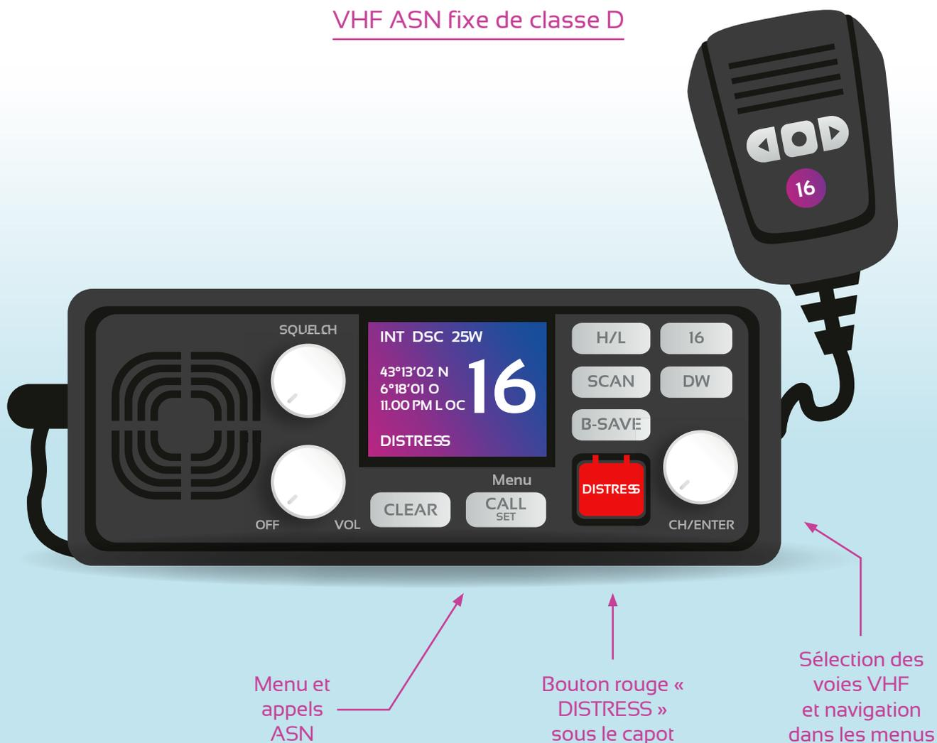
Toute VHF ASN fixe doit être programmée avec le MMSI affecté à la station de navire. La position géographique du navire doit être transmise automatiquement afin d'être incluse dans toute alerte de détresse envoyée.
